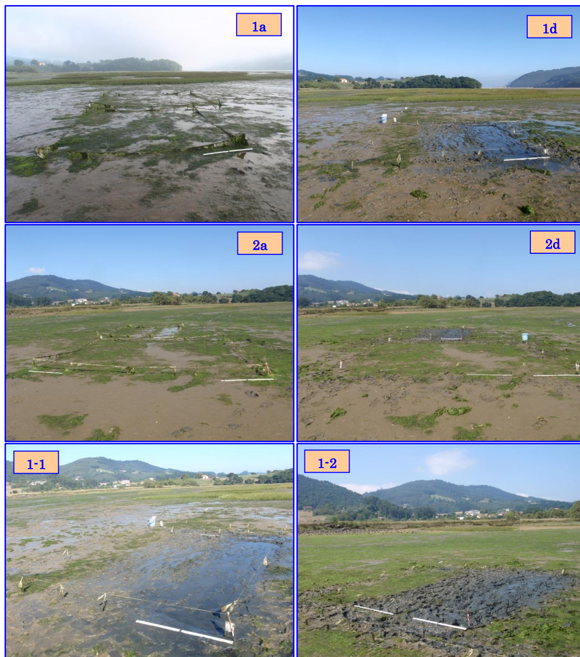
Figura 75.- Parcelas de experimentos, mes 4 (5 de septiembre de 2013). Antes (1a y 2a) y después (1d y 2d) de la limpieza de algas. Parcelas del experimento del pisoteo después de ejercer la presión en los pasillos C y D arenoso (1-1) y fangoso (1-2).
