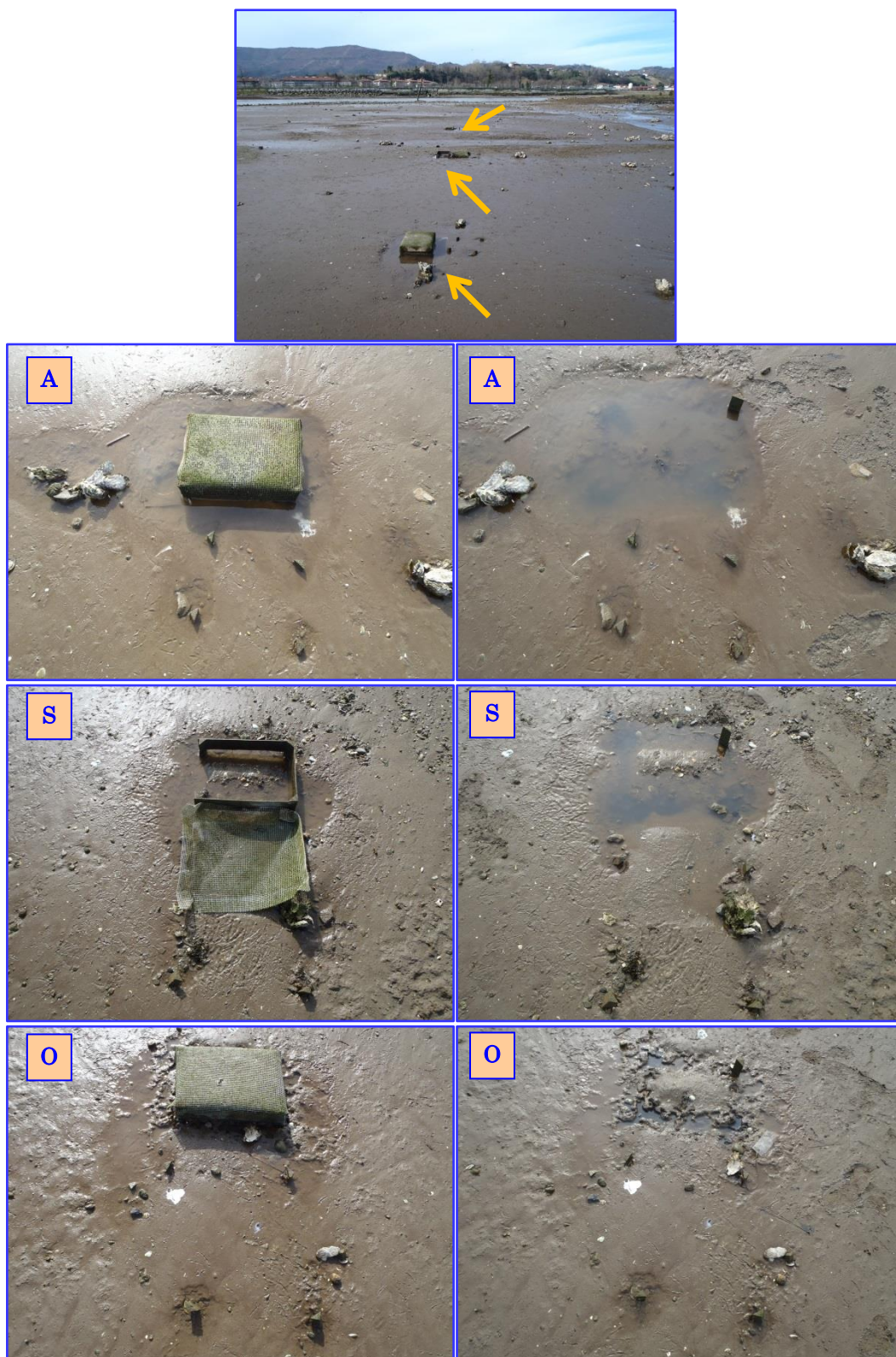
Figura 32. Bidasoa (Plaiaundi), febrero 2013. Las tres cajas alineadas en la marisma, y aspecto de cada zona con y sin cajas (A-Caja colocada en agosto; S-Caja colocada en septiembre; O-Caja colocada en octubre).
