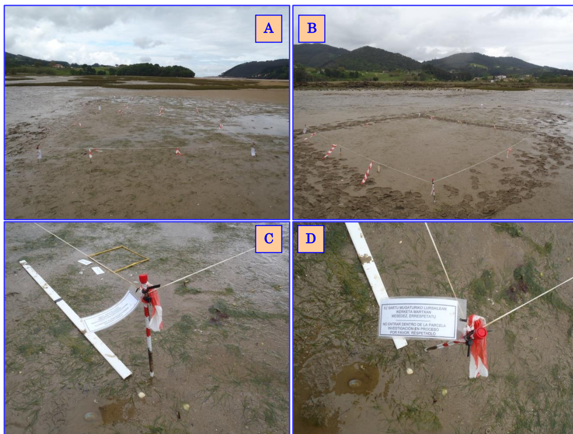
Figura 61.- Instalación de las parcelas. 02/05/2013. A. Parcela en la zona arenosa; B. Parcela en la zona fangosa; C. Detalle de una de las barras de las esquinas; D. Detalle de la etiqueta de información del experimento.
